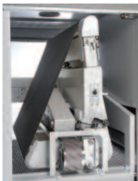
oben: WEBER X-Schleifaggregat mit Querband und Breit(Längs)band bestückt unten: Verwaltung in Kronach, Bamberger Straße; Fertigung in Kronach, Industriestraße
